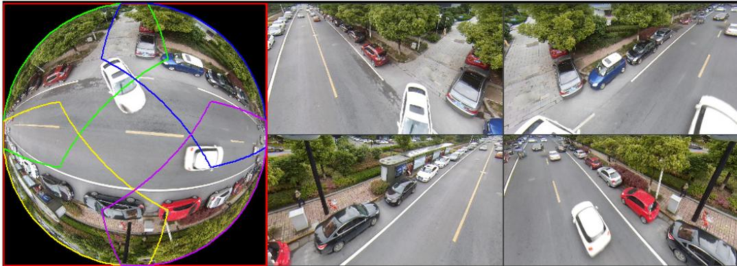
In Abbildung 4-75 stellen Sie die Farbe links im Bild ein oder verändern Sie mit der Maus die Position der Miniaturbilder rechts im Bild, um die Fischaugen-Entzerrung zu aktivieren.
